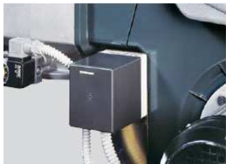
Příklad servomotoru pro regulaci plynu/vzduchu
